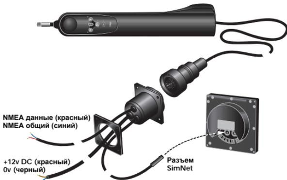
Рис. 5.5. Установка и подключения гнезда кабеля на переборке
