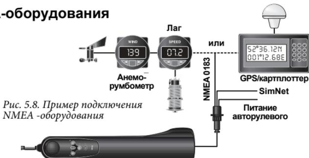
Рис. 5.8. Пример подключения NMEA -оборудования
