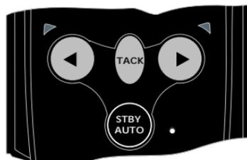
Рис. 2.3. Включение автоматического режима
